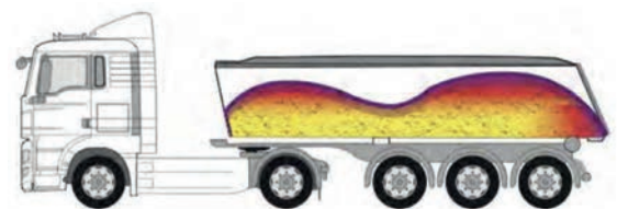
Fig. 3: Warmer layer in the lower part Source: Fliegl Martin, Studies in asphalt building, Fliegl Bau- und Kommunaltechnik GmbH.
