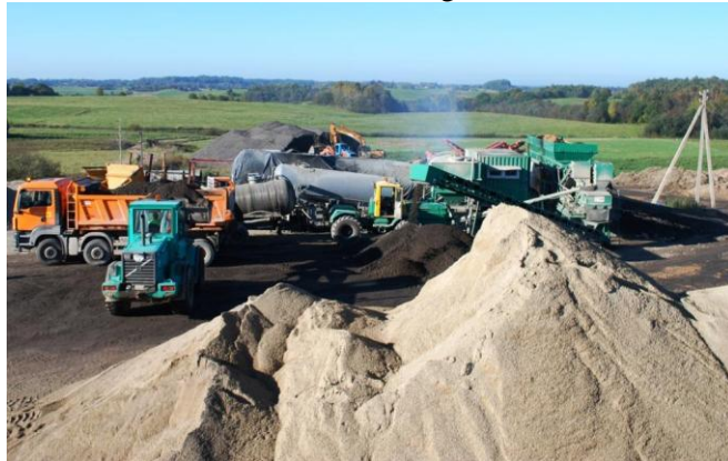
Figure 3. KVM mobile cold mix asphalt plant of JSC “Žemaitijos keliai”.
